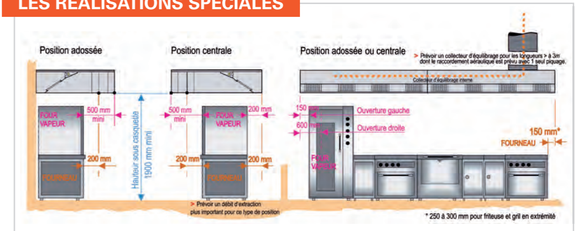
■ Dimensionnement d'une hotte de cuisine version standard / simple flux
