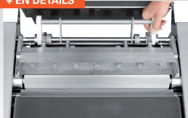
■ Changement de lame rapide sans outillage (option)
